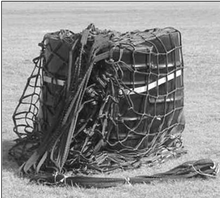
Figure 2-5. Sling-Load Cargo Net
